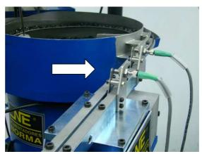
Para casos em que devido às características construtivas da peça a ser alimentada, o funcionamento do Alimentador é prejudicado nas situações em que ocorre o completo abastecimento da Calha de Transferência (Fluxo Livre). Nestes casos a solução técnica recomendada é a instalação de um Sistema de Controle de Nível (ASSN), o qual liga e desliga o Alimentador de peças quando o abastecimento da calha atinge os níveis mínimo e máximo respectivamente.
